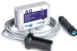
Alarma de nivel de grasas        | 53620620 | Alarma de nivel máximo de grasas y ausencia de agua. Con Unidad de control IP65 fabricada en policarbonato. Sonda capacitiva IP68. Con salida de relé sin potencial para monitorización y control. Alimentación: 230 V. Longitud cable: 10 m                                                                                                                       |
