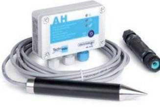
Alarma de nivel de hidrocarburos | 53620630 | Alarma de nivel máximo de hidrocarburos. Con seguridad intrínseca y certificación ATEX. Con Unidad de control IP65 fabricada en policarbonato. Con caja de conexiones. Sonda de conductividad para hidrocarburos IP68. Sonda ultrasónica para lodos IP68. Con salida de relé sin potencial para monitorización y control. Alimentación: 230 V. Longitud cable: 5 m |
