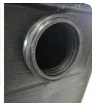
Mettre en place les joints fournis (respecter le sens de mise en place)
