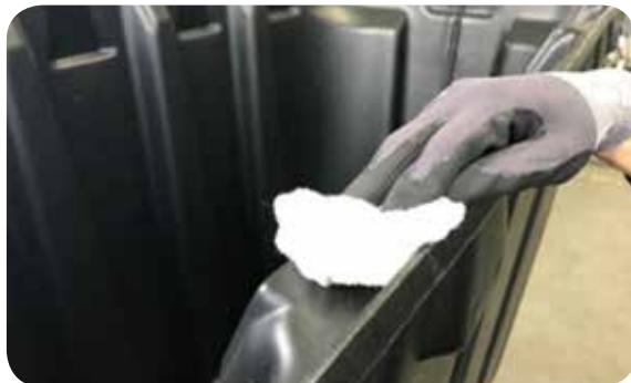
Rand des Tanks mit einem trockenen Tuch reinigen, nötigenfalls entfetten
