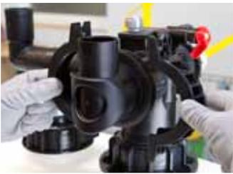
17- Fixer le coude d'aération Ø70 **8** sur le raccord de base **1** à l'aide de deux demi-bridés **9**.
