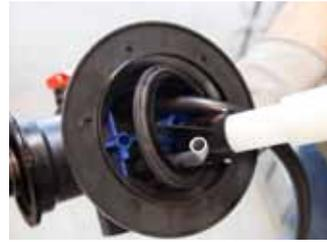
3- Clipser le tube télescopique **2** dans le raccord complémentaire **14**.
