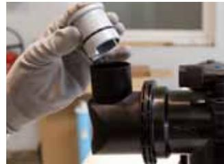
15- Emboîter le bouchon aération **11** dans le coude d'aération Ø70 **3**.
