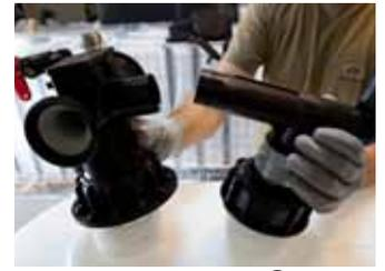
12- Emboiter le raccord de base **1** avec l'ensemble Tê fileté 2 pouces / Sifflet.
