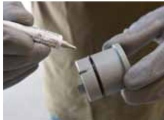
14- Mettre de la graisse **6** sur le joint du bouchon obturation aération **11**.
