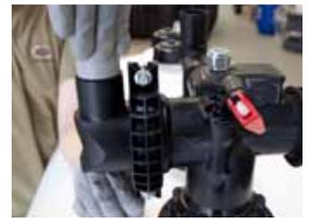
20- Emboiter le bouchon obturation aération **11** dans le coude d'aération **8**.
