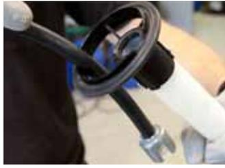
2- Faire passer le tube de soutirage du raccord de base **1** dans la grande alvéole du tube télescopique **2**.
