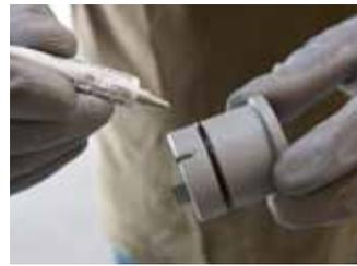
19- Mettre de la graisse **6** sur le joint du bouchon obturation aération **11**.
