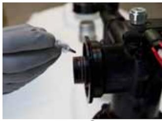
14- Mettre de la graisse **6** sur le joint de l'aération du raccord de base **1**.
