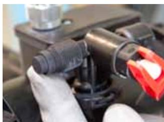
21- Mettre le bouchon caoutchouc **12** sur la sortie du soutirage.
