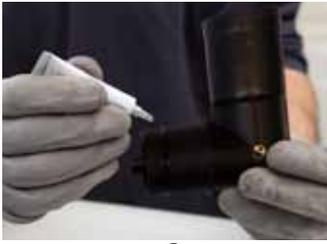
9- Mettre de la graisse **6** sur le joint du coude d'aération Ø40 **7**.
