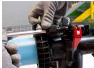
18- Emboîter le tube de soutirage **15** et serrer les écrous en plastique **15**.
