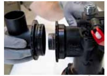
16- Emboiter le coude d'aération Ø70 **8** sur le raccord de base **1**.
