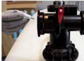
6- Mettre de la graisse **6** sur le 2ème joint du remplissage du raccord complémentaire **1**.
