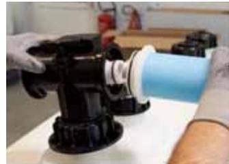
8- Emboîter le tube plastique remplissage / aération **15** sur le raccord complémentaire **14** puis serrer les écrous.
