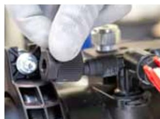
22- Fixer le bouchon caoutchouc **12** à l'aide de l'écrou plastique **13**.
