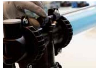
20- Fixer le bouchon caoutchouc **12** à l'aide de l'écrou plastique **15**.
