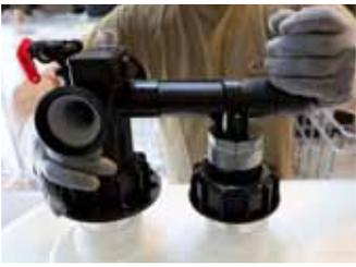
13- Visser l'écrou de l'ensemble Tê fileté 2 pouces/ sifflet et l'écrou de l'ensemble de base.
