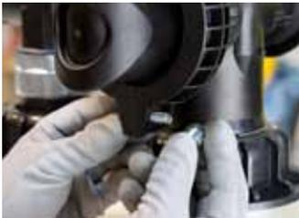
13- Assembler les deux demi-bridés **9** à l'aide des 2 vis. m8x30 + 2 Ecrous M8 **10**.
