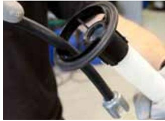
2- Faire passer le tube de soutirage du raccord complémentaire **14** dans la grande alvéole du tube télescopique **2**.
