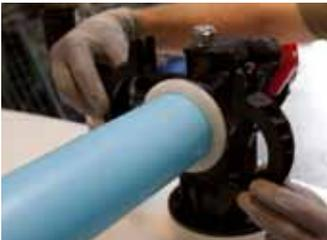
9- Fixer le tube plastique remplissage / aération **15** sur le raccord de base **1** et sur le raccord complémentaire **14** à l'aide des quatre demi-bridés **9**.
