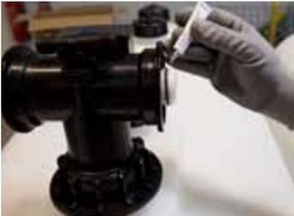
5- Mettre de la graisse **6** sur le 1er joint du remplissage du raccord Complémentaire **14**.
