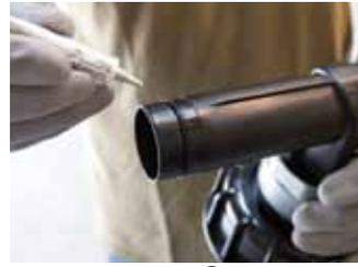
11- Mettre de la graisse **6** sur le joint du Tê fileté 2 pouces **4**.
