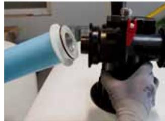
7- Emboîter le tube plastique remplissage / aération **15** sur le raccord de base **1**.
