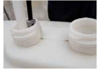
4- Faire passer le tube télescopique et le tube de soutirage dans la deuxième bonde du réservoir.
