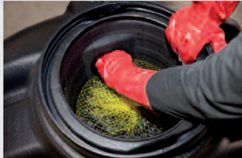
2 – Introducir la mano en el manguito reemplazable para agarrar la empuñadura
