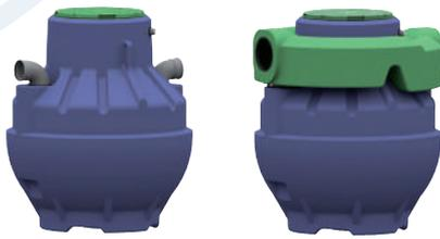
Separadores de hidrocarburos fabricados en polietileno, con decantador, filtro coalescente y obturador automático, de Clase I (vertido < 5 mg/l), con marcado CE, conformes a la Norma UNE-EN 858. En todas las capacidades, existe una versión con bypass integrado (modelos SHCOABP).
