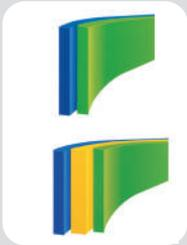
Además de estas características comunes a la técnica de extrusión soplado, **RIKUTEC** dispone de la tecnología de coextrusión-soplado en varias capas, que permite separar el proceso de extrusión de cada capa, de forma que se puede utilizar el material más apropiado para cada una de ellas, como polietileno de diferentes colores, propiedades o características; incluso en el caso de piezas asimétricas, otorgando al producto unas características mecánicas eficientes y un acabado superficial óptimo.
