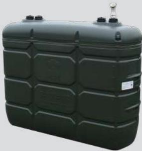
Depósitos para almacenamiento de aceite usado compuestos por un depósito Confort XT y un acoplamiento en codo para descarga de aceite usado fabricado en acero de diámetro 2" y longitud (interior de depósito) 1615 mm. Incluye tapón de cierre y tubo de aspiración.
