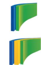
Además de estas características comunes a la técnica de extrusión-soplado, RIKUTEC dispone de la tecnología de coextrusión-soplado en varias capas. Este proceso de fabricación, permite separar el proceso de extrusión de cada capa, pudiéndose utilizar el material más apropiado para cada una de ellas, como polietileno de diferentes colores, propiedades o características.
